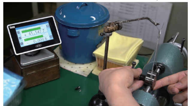
三針法によるねじ有効径測定（比較測長機使用）
